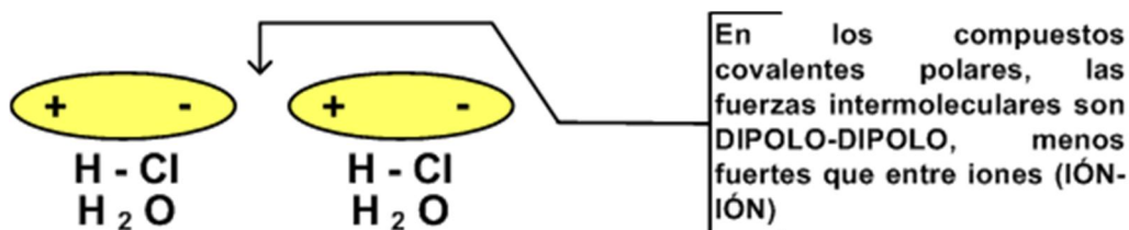
Figura 4. Fuerzas de atracción entre compuestos COVALENTES POLARES. En estos compuestos los puntos de fusión y ebullición son medianamente altos, pero menores que en los compuestos iónicos. Ejemplo HCl y H 2 O.
